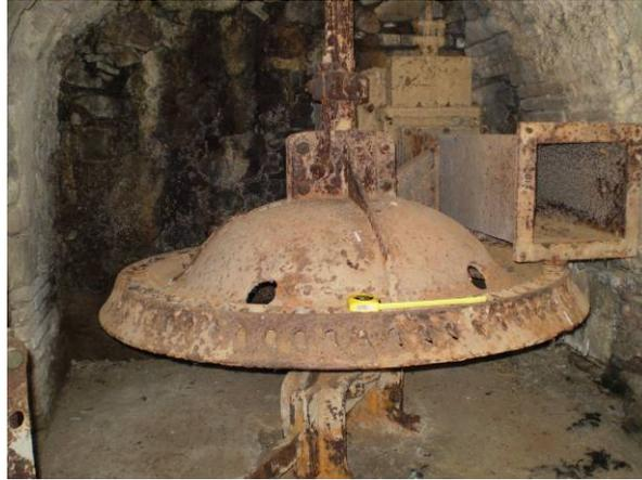
Fig. 6. Rodete y conducto del molino de Gaserans. En condiciones de uso, la sección rectangular al final del conducto está cerrada [4].
