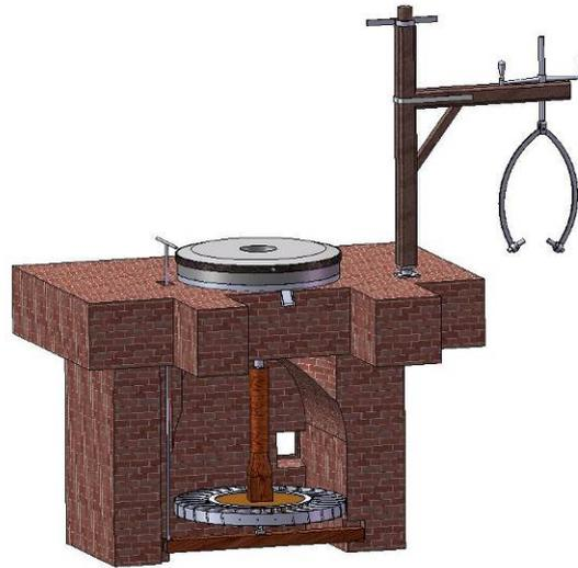
Fig. 2. Representación virtual del molino hidráulico de rodete horizontal de Besalú. [1]. Las principales partes están definidas en el texto.
